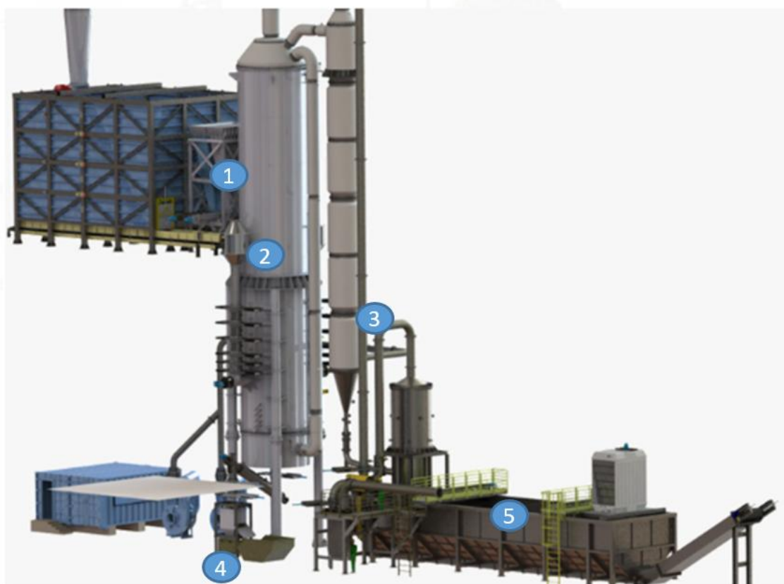
Figura 05: Equipamentos do processo de gaseificador: (1) entrada de CDR, (2) Reator, (3) lavador de gases, (4) coletor de cinzas, (5) baía de armazenagem do efluente de lavagem
