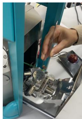
Figura 02: (a) equipamento MEV (b) inserção de amostras no MEV
